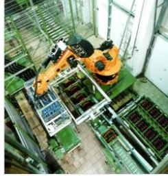
Heute setzt Pyraser zwei mit **Pneumatik-Greifern** ausgestattete **KUKA-Roboter KR 150 ein**, die ihren Dienst jeweils eine Schicht lang an drei Tagen pro Woche verrichten. Im Vergleich zum früher verwendeten konventionellen Maschinenpark mit Palettieranlagen reduzierte sich der Platzbedarf um rund 150 m<sup>2</sup>, ein entscheidendes Kriterium zugunsten der **sechsschigen Knickarmroboter**. Die Kosten für die Zelle entsprachen denen für herkömmliche Technik.
