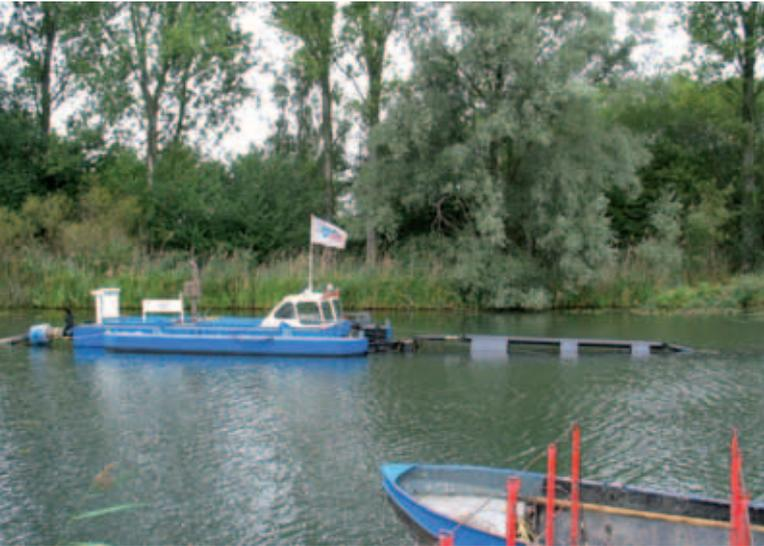
*Saugbagger im Eggensteiner Altrhein: Ein Saugkopf am Ende der in der rechten Bildhälfte erkennbaren Rohrleitung nimmt den Schlamm auf. Über eine flexible Rohrleitung, links im Bild zu sehen, wird der Schlamm auf ein Spülfeld befördert.*
