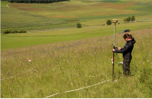
Abbildung 3.1: Eine Mitarbeiterin des ILU beim Einmessen einer Monitoringfläche im Fördergebiet Baaralb bei Fürstenberg. Foto: T. Kring/NGP Baar
