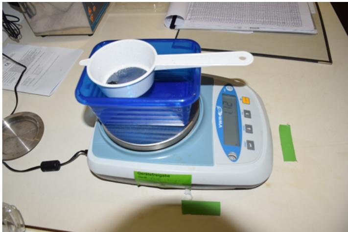
Abbildung 4.3: Vorbereitung des Wiege-Vorgangs (links), Probenfraktion auf der Waage mit Wiegeschale und Sieb (rechts). Fotos: gaic
