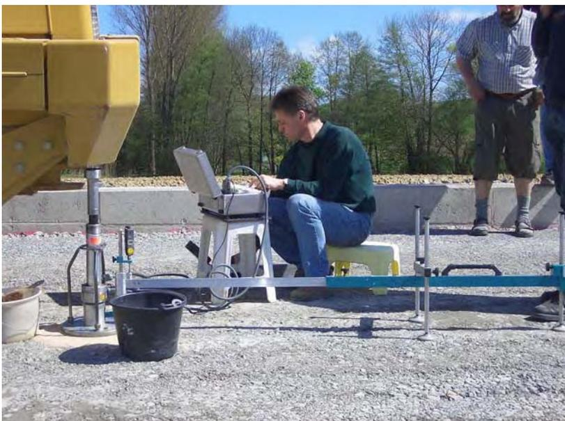
Lastplattenversuch zur Verdichtungskontrolle der Mineralschotterschicht
