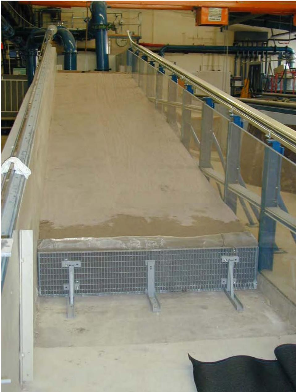
**Foto 1** Ansicht des Halbdammodells ohne Böschungssicherung, Blick von unterstrom
