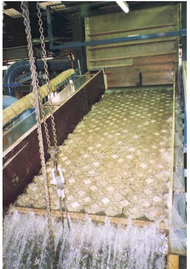
**Belastungsuntersuchungen an durchlässigem, selbsttragendem und kohärentem Deckwerk**
