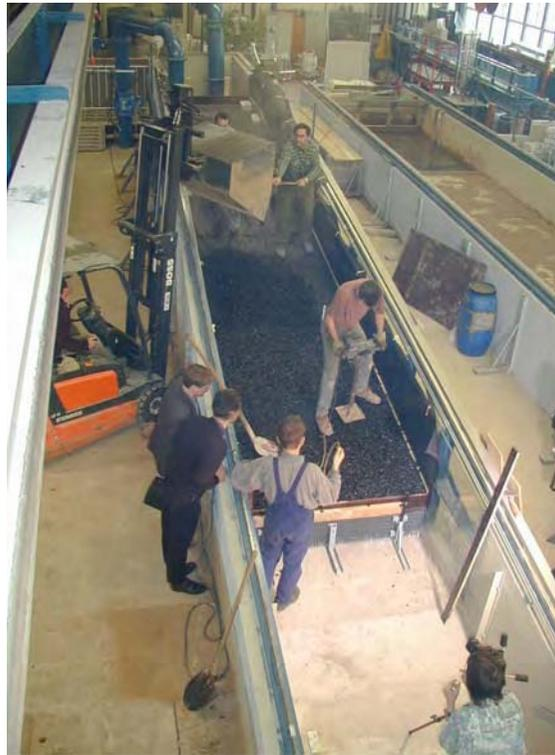
**Foto 7** Einbau des Mastix-Schotters auf das Geogewebe
