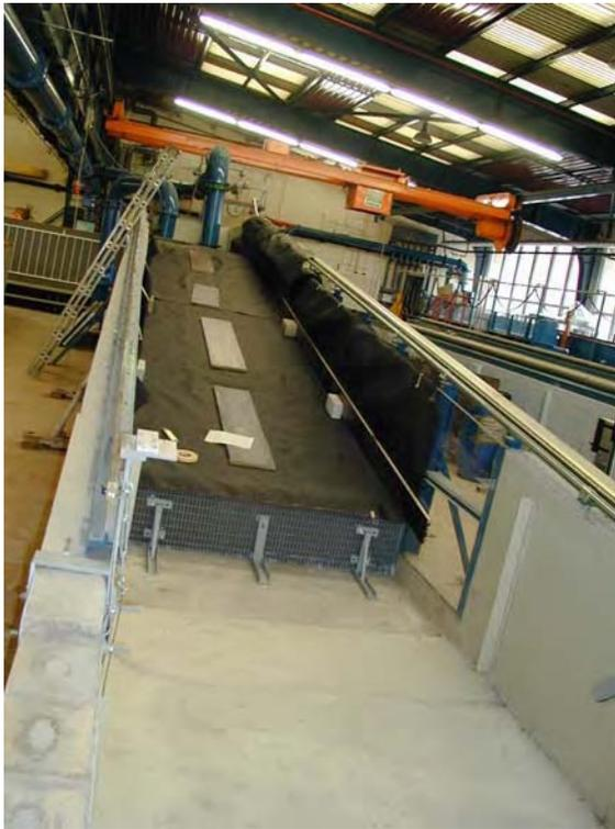
**Foto 6** Auf der Sandoberfläche verlegtes Geogewebe zur Gewährleistung der Filterfestigkeit
