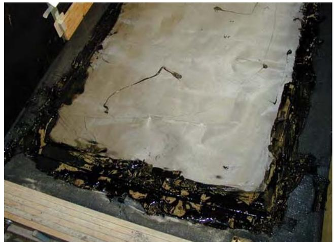
Eingepackte Sandschicht: Edelstahl-Gewebe mittels Bitumen auf Geogewebe geklebt (unterer Erosionsschutz)
