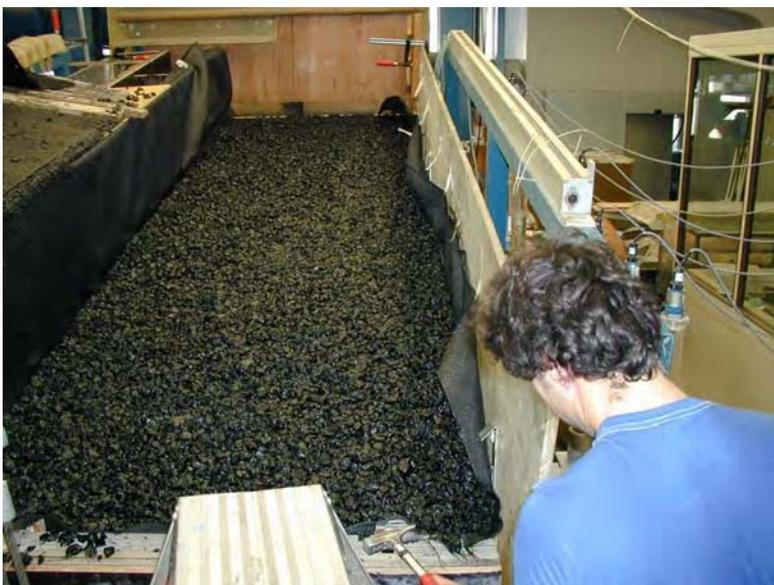
Mastix-Schotter-Deckwerk nach dem Einbau
