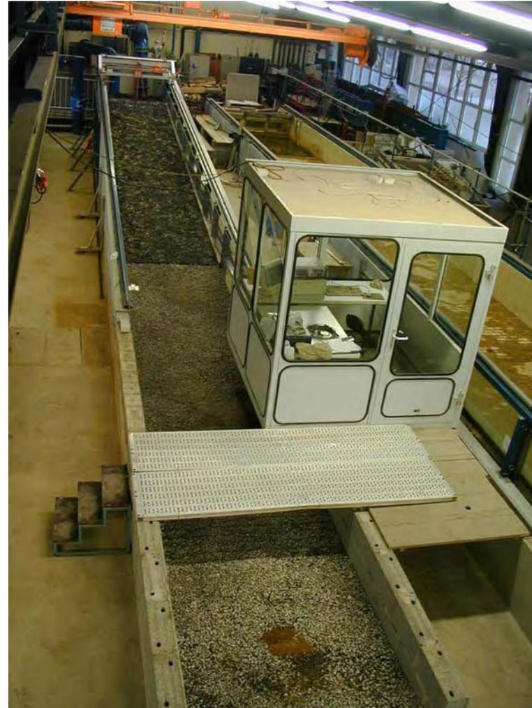
**Foto 13** Betriebsbereiter Versuchsstand (Halbdamm hinten, Auslaufstrecke vorn)
