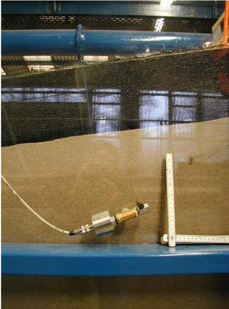
**Foto 12** Druckaufnehmer in der Plexiglaswand unterhalb des Deckwerkes aus Mastix-Schotter (hinter Geogewebe)
