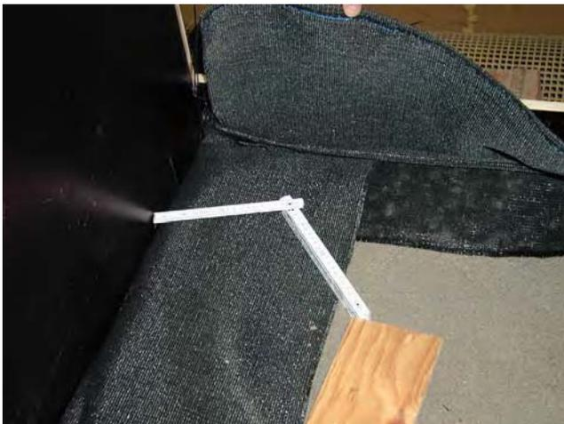
Einlaufbereich: Geogewebe als untere Erosionsschutzumhüllung des Sandpolsters
