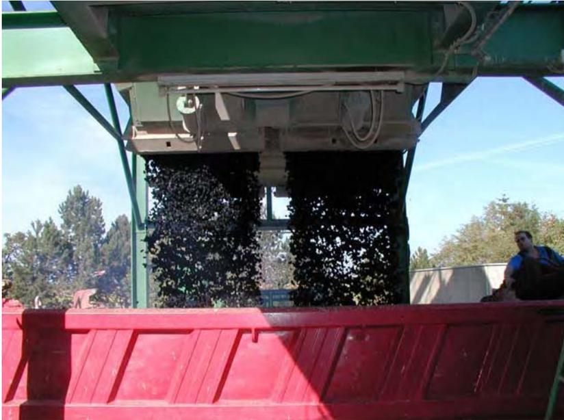
Befüllung der LKW im Mischwerk
