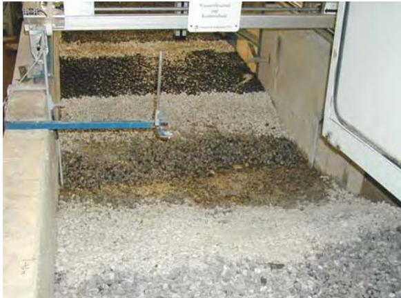
Kolkbereich am Böschungsfuß
