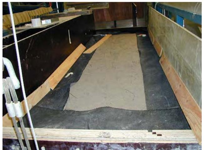
Sandschicht eingeschlagen in Geogewebe als untere Erosionsschutz-Hülle des Sandpolsters
