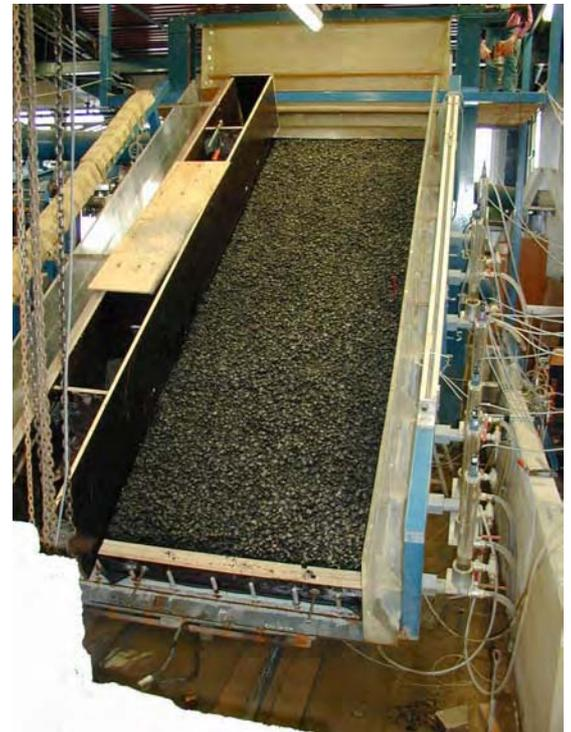
**Belastungsuntersuchungen an durchlässigem, selbsttragendem und kohärentem Deckwerk**
