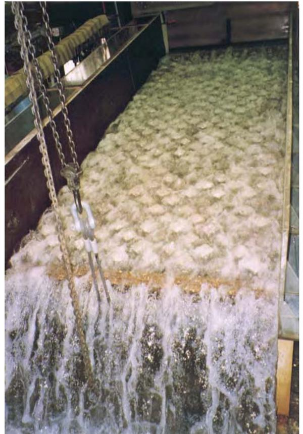
**Belastungsuntersuchungen an durchlässigem, selbsttragendem und kohärentem Deckwerk**
