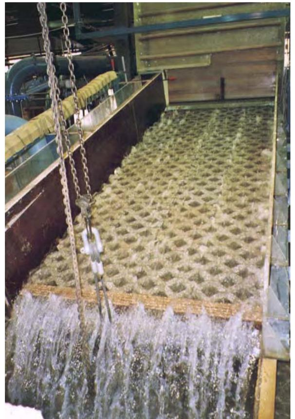
**Belastungsuntersuchungen an durchlässigem, selbsttragendem und kohärentem Deckwerk**
