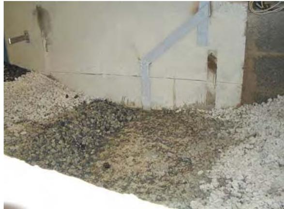
Kolkbereich am Böschungsfuß
