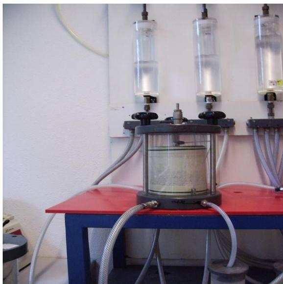
Abb. 3-1: Aufbau eines Durchströmungsversuchs in einer Triaxialzelle
