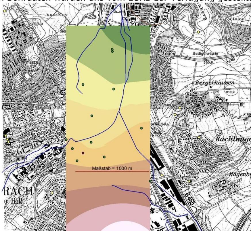
Abb. 5-14: Grundwassergleichenplan; Grüne Punkte stellen Grundwasserpegel dar, der rote Punkt die Erdwärmesonde
