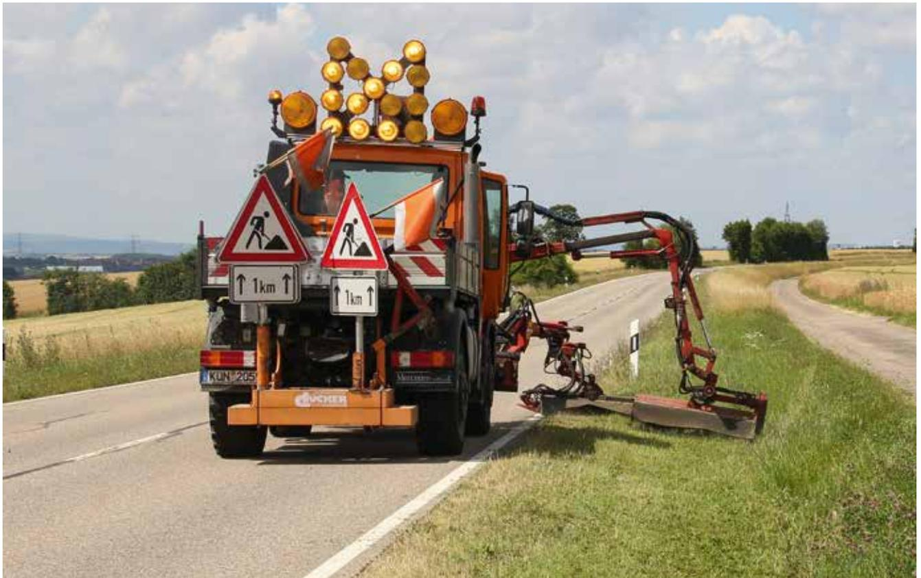
Pflege des Intensivbereichs mit Randstreifenmähergerät und Böschungsmähergerät.
