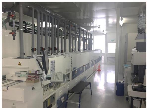
Abbildung 5: Integration einer Inline-Nasschemieanlage sowie entsprechender Spurenanalytik-Messtechnik (rechte Bildhälfte).
