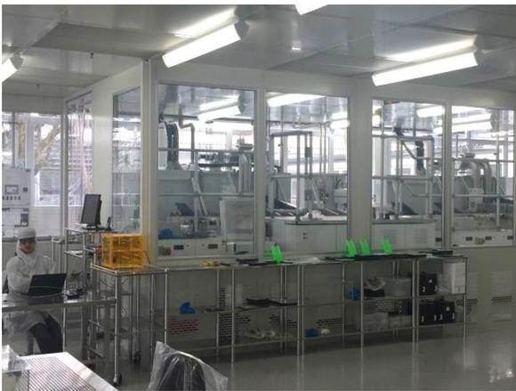
Abbildung 2: Integration großflächiger PECVD Beschichtungsanlage. Der Eingangs- und Ausgangsbereich befindet sich innerhalb des Reinraums, die Anlage selbst sowie die zugehörige Infrastruktur (Pumpen, etc.) ist dagegen abgetrennt außerhalb aufgebaut.
