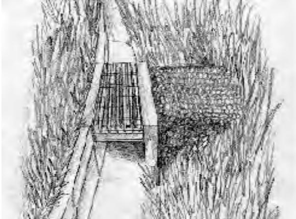
**Links: Müssen bei ansteigendem Gelände die Rampenausstiege tiefliegender Durchlässe mit einer Gegenwand gesichert und mit einem Gitterrost abgedeckt werden, darf durch eine Anschüttung die Sperrwirkung nicht vermindert werden. Über die Anschüttung können wandernde Amphibien auf den Rost und evtl. auf die Straße gelangen.**
