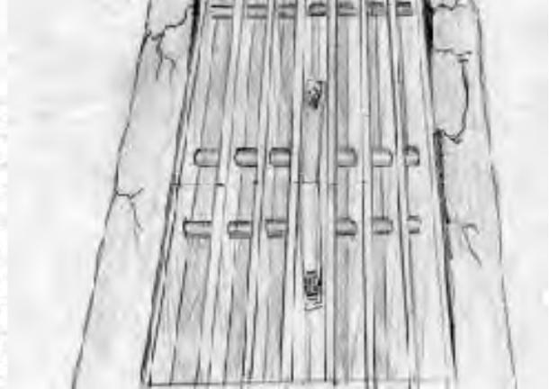
**Die Bauhöhen von Gitterrost und Leitsystem müssen aufeinander abgestimmt sein!
