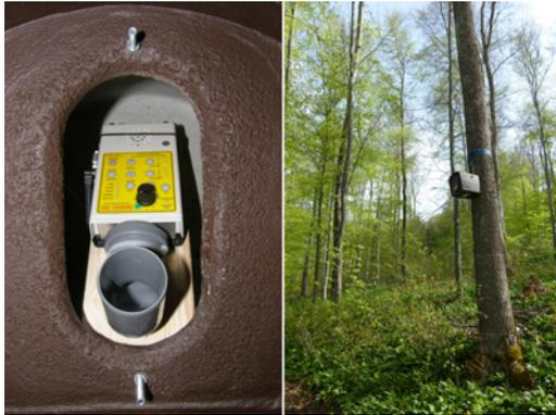
Abbildung 2.3: Detailansicht des Aufnahmesystems (links) und Anbringung an einem Baum im Untersuchungsgebiet „Baaralb bei Geisingen“ (rechts). Fotos: Horst Schauer-Weisshahn
