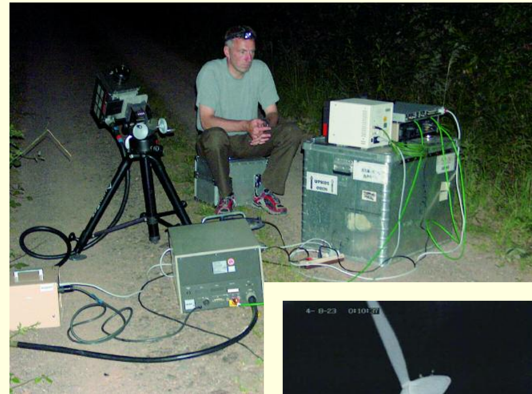
Mit Hilfe einer Wärmebildkamera ist die Beobachtung von Fledermäusen auch bei völliger Dunkelheit möglich. Sämtliche Beobachtungen werden digital aufgezeichnet und können somit am nächsten Tag nochmals überprüft werden. Das untere Bild zeigt beispielhaft das auf dem Monitor sichtbare Bild.
