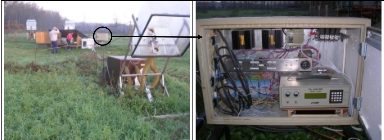
Abbildung 10: Aufbau des Hohenheimer Messkammer-Systems (links) und Steuerungs-/Messtechnik (rechts) zur Erfassung des Effluxes klimarelevanter Gase aus Böden im Feld der Versuchsstation Stuttgart-Kleinhohenheim
