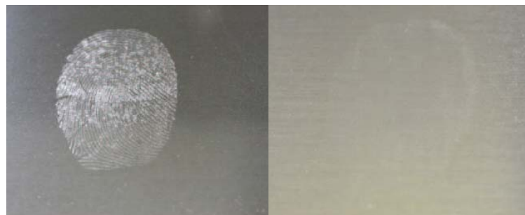
Abbildung 6: Edelstahloberfläche, links ohne, rechts mit Anti-Fingerprint Ausrüstung (Quelle: ThyssenKrupp 2005)
