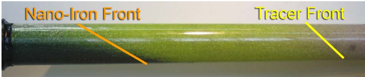
Abb. 13: Retardation beim Transport von Nano-Eisen
