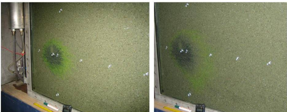
Abb. 3: Ausbreitung einer Nanoeisen-Suspension und eines konservative Tracers
