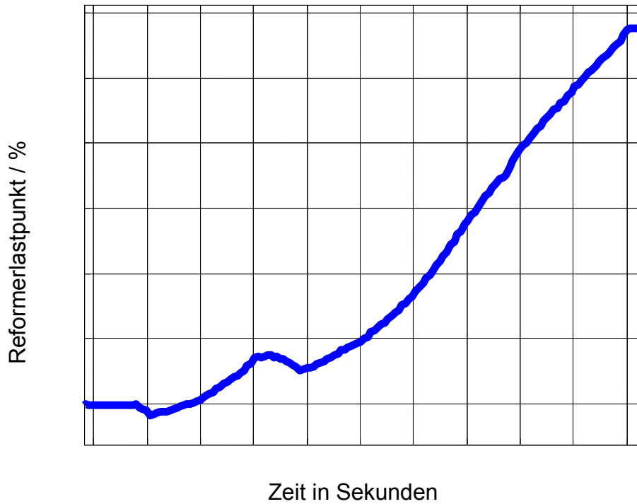
Abb. 3-53: Reformer-Lastwechsel von 70 % auf 100 %, mit Störung bei ca. 9400 s.
