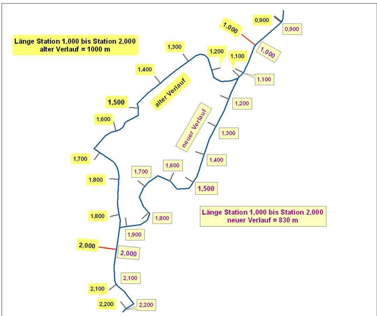
Abbildung 1: Anpassung der Basisstationierung bei Veränderung der Gewässer geometrie
