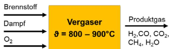
Abbildung 2.3: Schematische Darstellung der Wasserdampfsauerstoffvergasung.
