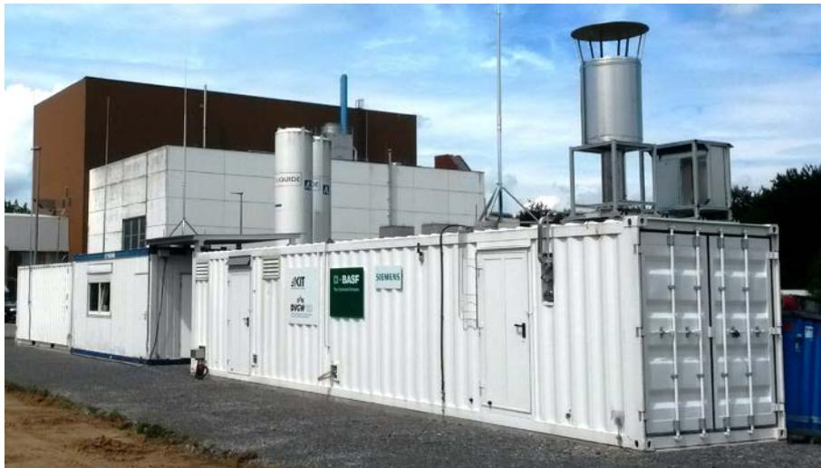
Abbildung 3.19: DemoSNG Wabenmethanisierung für 10 m<sup>3</sup>/h SNG auf dem Gelände des KIT Campus Nord.
