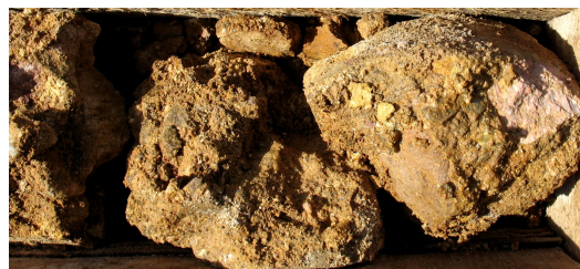
Abbildung 9.11: Die Breisgau-Formation in der Randfazies besteht ausschließlich aus meist stark verwittertem Lokalmaterial (hier Schwarzwaldmaterial, Bohrung B27, Parksiedlung Bad Krozingen, 18,0 – 20,0 m u. GOK, bzw. Detailansicht LGRB-Nr. Bo 8012/1270).
