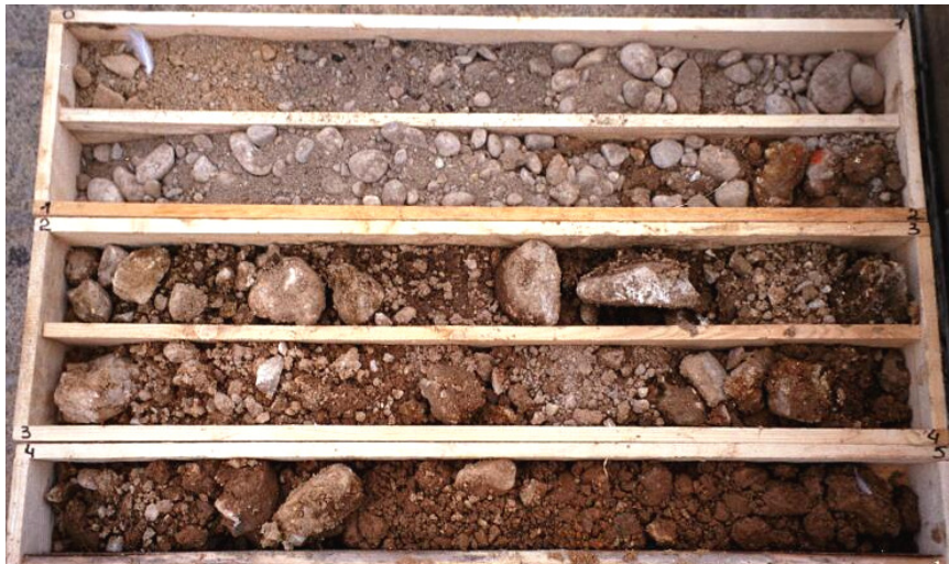
Abbildung 9.7: Jungquartäre Flusskiese und -sande (Bohrung LGRB-Nr. 8011/917, 0 – 5 m u. GOK, Klemmbachtal bei Müllheim). Figure 9.7: Gravieres sableux fluviatiles du Quaternaire récent (Forage 8011/917, 0 à 5 m, vallée du Klemmbach près de Müllheim).
