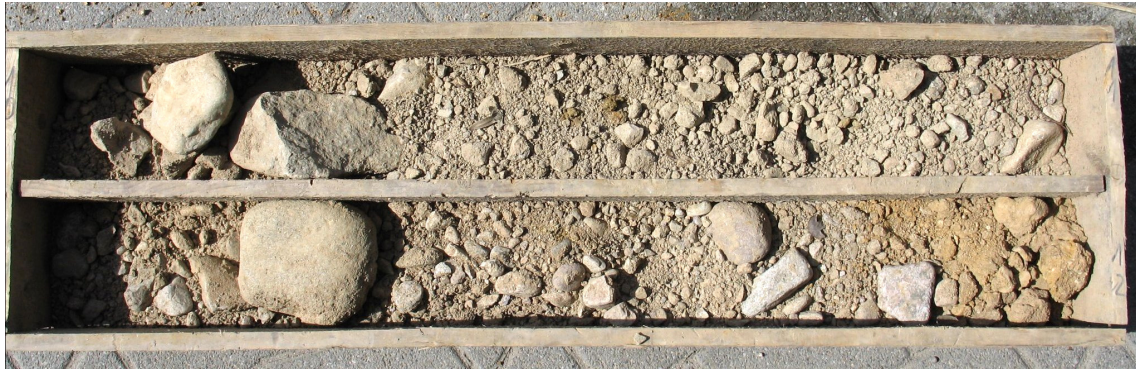
Abbildung 9.6: In der Neuenburg-Formation überwiegen am Grabenrand die Komponenten lokaler Herkunft (hier: Bohrung B27 Parksiedlung Bad Krozingen (LGRB Archiv-Nr. 8012/1270) mit überwiegend Schwarzwaldmaterial). Figure 9.6: Dans la Formation de Neuenburg les éléments d'origine locale dominent sur la bordure (photo: forage B27 de la Cité du Parc à Bad Krozingen, forage 8012/1270).
