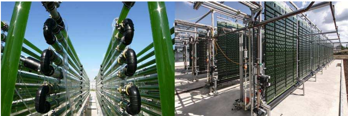
Abbildung 2: Links: Röhren-Photobioreaktor an der Universität Wageningen in den Niederlanden [ http://www.biosolarcells.nl/en/onderzoek/algen/06.06.2018 ]
