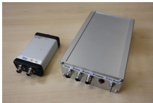
Bild 26: Links: Drucksensor Speisung mit Konstantstromquelle. Rechts: Signalvorverstärker mit einer 9V Block Batterie als Speisespannung.
