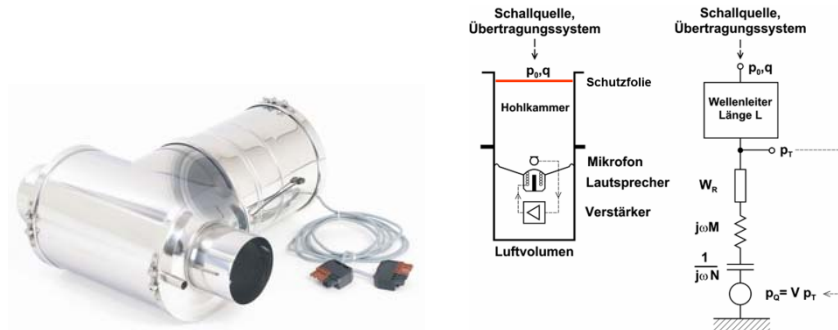
Bild 1: Foto, Schnittdarstellung und Funktionsprinzip des Aktiv+ Schalldämpfers.
