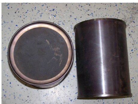
Bild 5: Rußpartikelfilter der Fa. Tehag von Typ CWF-600 (Catalysator-Wallflow-Filter). Der Partikelfilter hat einen Außendurchmesser von 244 mm und eine Länge von 320 mm.
