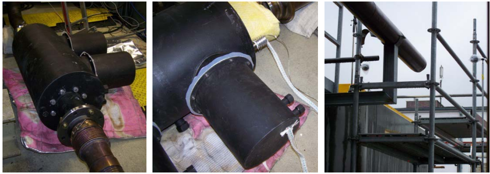
Bild 32: Links: Aktiver Versuchsschalldämpfer im Abgasstrang des Dieselmotors. Mitte: Drucksensor und Lautsprechergehäuse. Rechts: Mikrofone an der Abgasmündung.
