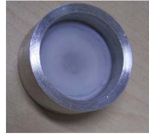
Bild 14: Skizze der Membranhalterung mit Mikrofonkühlung und Foto der Membranhalterung ohne Alu-Kühler.
