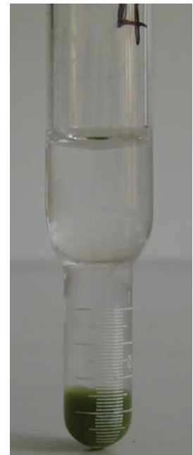
Abb. 4-4: Links: Prozentualer Anteil des Absatzvolumens (normiert auf gleiches Volumen pro Tiefenstufe) der einzelnen Tiefenstufen an der Station Fischbach-Uttwil im Jahr 2016. Rechts: Bestimmung des Absatzvolumens mit kalibriertem Reagenzglaschen [LUBW].
