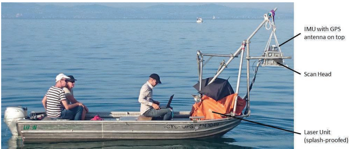
Abb. 6-19: Installation eines Laserscanners auf einem kleinen Aluboot (Bild: Kempf). (IMU = Inertial Motion Unit (Bewegungssensor)).
