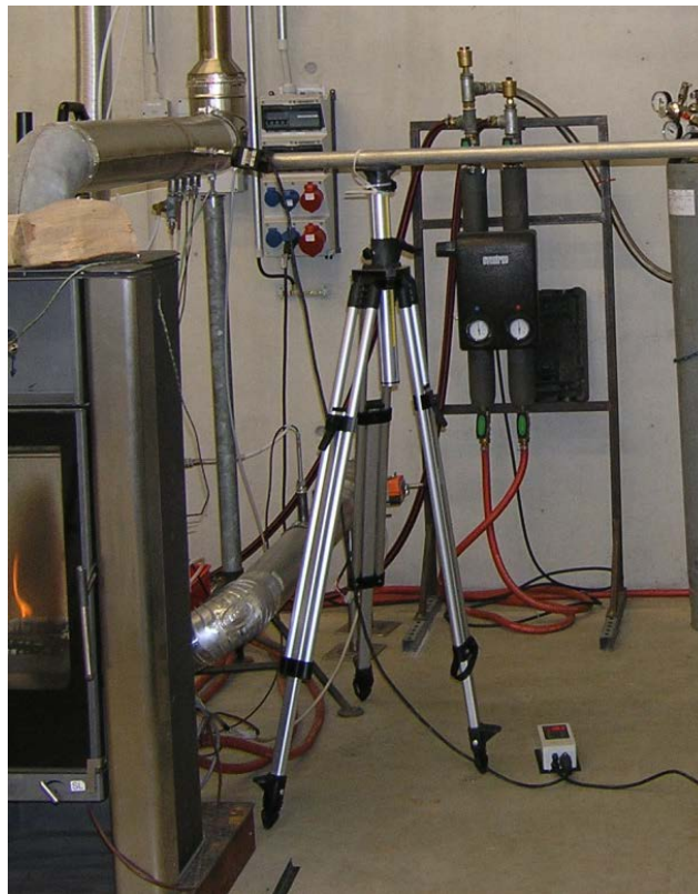
Abbildung 3.3 Geruchsprobenahme mit beheizter Sonde und Anordnung der Messstelle für Versuchsstand I
