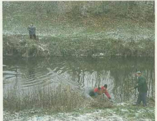
Abb. 21: Ermittlung der Wassertiefe mittels Peilabstich.
