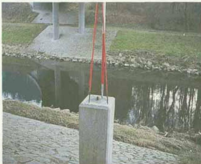
Abb. 31: Festpunkt als Betonstein, an der Fils.
