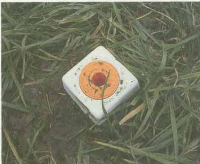
Abb. 30: Querprofilvermarkung Schlagmarke – Hektometerstein an der Murr.
