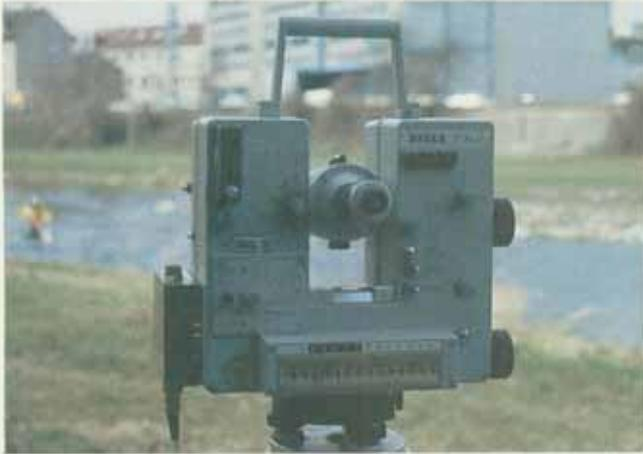
Abb. 19: Querprofilaufnahme mit Theodolit ...
