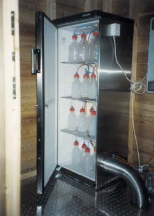
Abbildung 5.1-3: Thermostatisierter Probenkühlschrank für Sickerwasserproben
