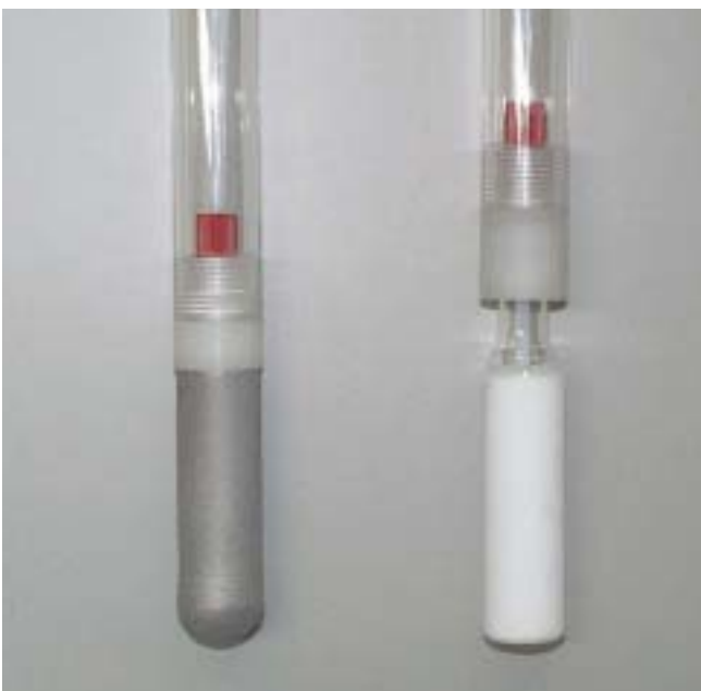
Abbildung 5.1-1: Links die SITEC/UMEG-Edelstahlsaugkerze, rechts die UMEG-Borsilikatsaugkerze
