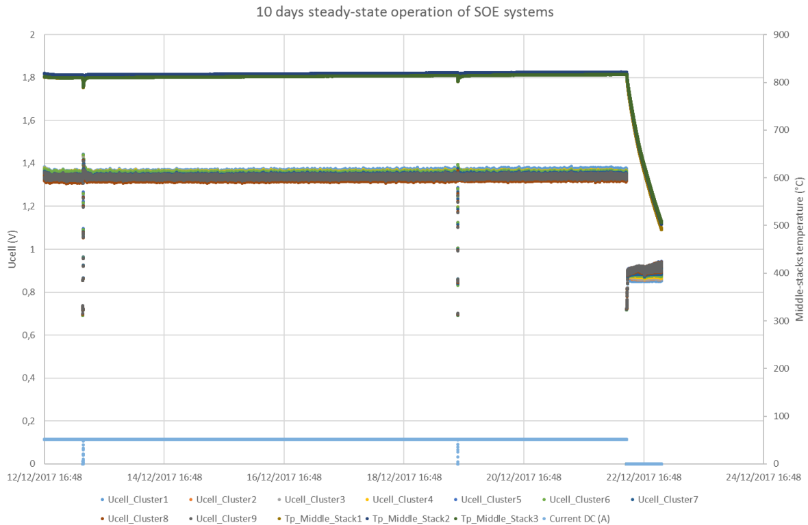
Abbildung 5: 10 Tage Dauerbetrieb des SOEC-Systems.
