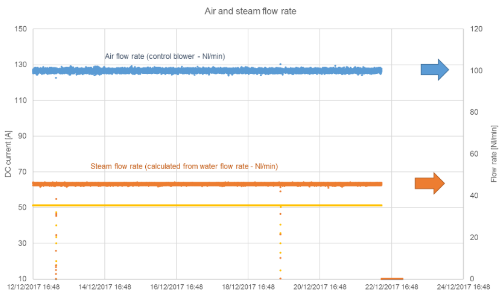
Abbildung 6: Dampf- und Luftdurchflüsse des SOEC-Systems
