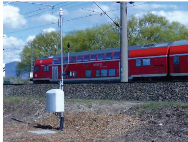
Abb. 7.6-3: Bahnlärmmessstation an der Rheintalbahn bei Achern. Foto: LUBW.
