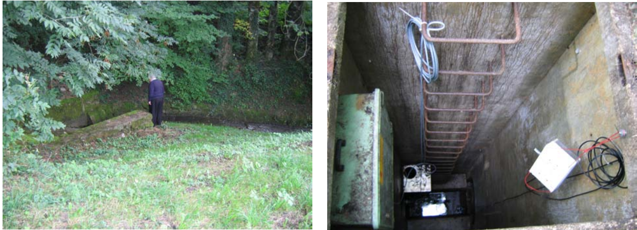
Abb. 4.23: Testgebiet Yverdon: Links: Schwinde Feurtille, Rechts: Schacht zur Karströhre in unmittelbarer Nähe der Schwinde mit Messreinrichtungen
