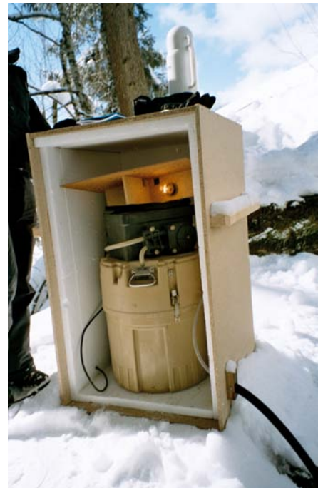
Abb. 4.18: Links: Markierungsversuch Hochwasser, Eingabe der Tracer direkt in den Wasserfall am Eingangsschacht (Foto: Andreas Wolf); Rechts: Markierungsversuch bei Niedrigwasser, Isolationsbox und automatischer Probenehmer an der Sägebachquelle bei -20°C
