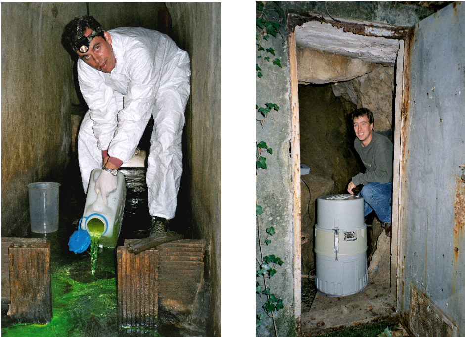
Abb. 4.25: Links: Eingabe des Fluoreszenzfarbstoffs direkt in die Schwinde, Rechts: Probenahme an der Moulinet-Quelle (Fotos: M. Pronk, N. Goldscheider)
