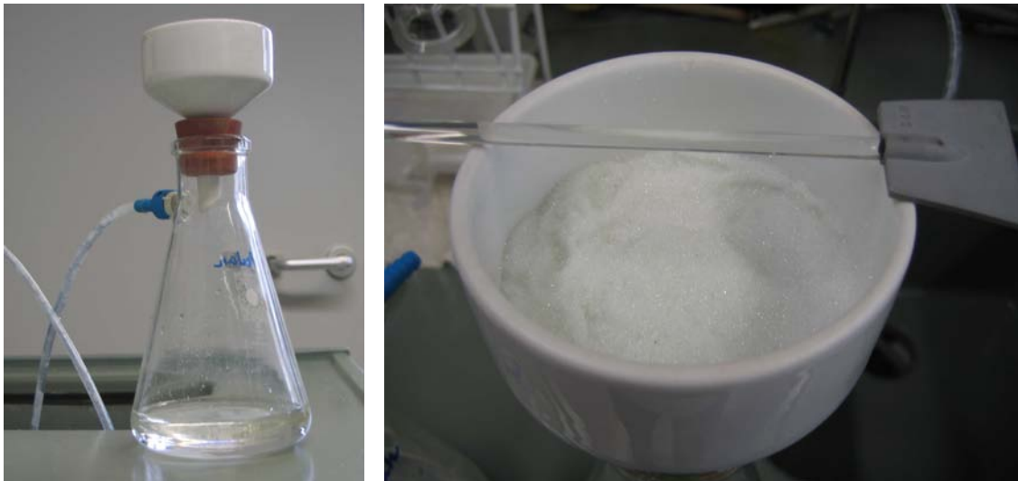
Abb. 3.6: Waschen der Probe mit Pentan (links), gewaschene Quarzperlen im Büchnertrichter (rechts)
