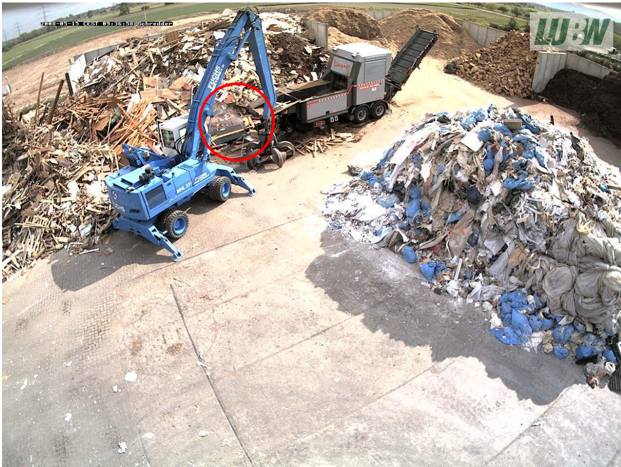
Abbildung 6-10: Befeuchtung des Input-Holzes in Segment 8 (Sprinkler rot markiert)
