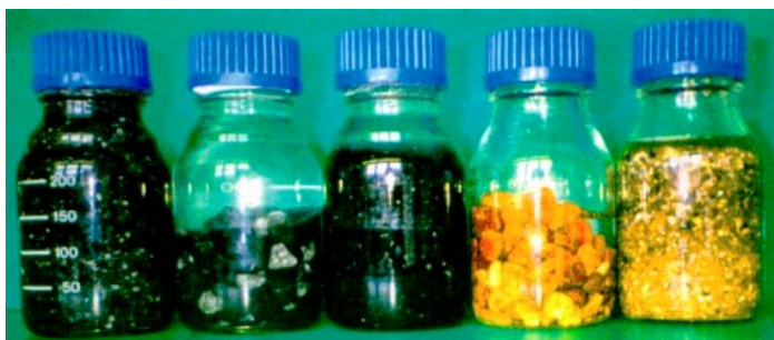
Abb. 5.4-3. Färbungen der Biofilme in der Wasseranlage. Festbettmaterial aus den Bioreaktoren (von links nach rechts): Denitrifikationsreaktor, Anaerobreaktor, Sandfilter 1, Aerobreaktor und Sandfilter 2.
