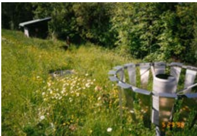
Abbildung 2.3-1: Die beiden Regenmesser nach Hellmann der Lysimeteranlage Egelsee im Illertal. Im Vordergrund der Regenmesser mit Windschutz (GW-Nr. 0403/769-4) und dahinter ein bodeneben aufgestelltes Gerät (GW-Nr. 0402/769-9). An diesem Standort ist kein freier Einfallswinkel von 45° vorhanden (siehe Bäume rechts im Bild).
