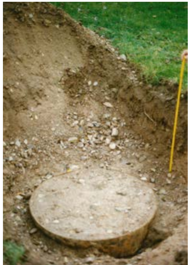
Abbildung 3.2-3: Lysimeterbehälter der Anlage Elgersweiler (GW-Nr. 0500/115-4) unter einer Streuobstwiese. Die Latte steht auf der Behälteroberkante. Die Einbautiefe betrug bis 1987 rd. 60 cm unter Flur.
