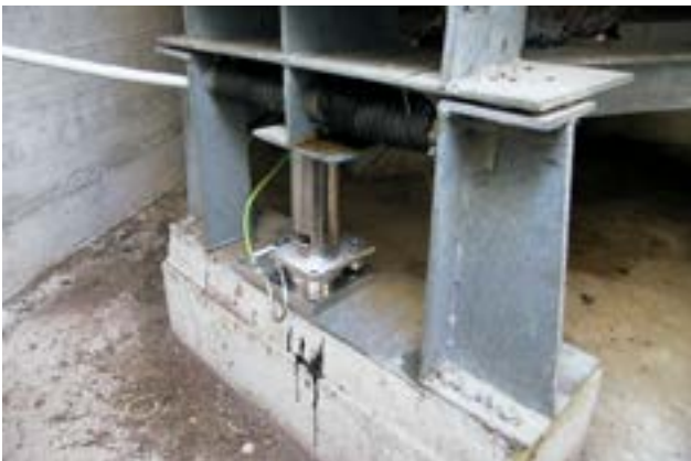
Abbildung 3.3-2: Wiegeeinrichtung des wägbaren Lysimeters Büchig (1 von 3 Druckmessdosen).
