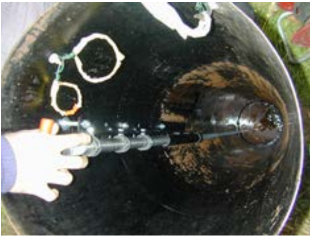
Abbildung 5.2-5: Fest installierte Handpumpe am Lysimeter Bonlanden (GW-Nr. 0501/769-0, links) und batteriebetriebene Elektropumpe am Lysimeter Elgersweier (GW-Nr. 0500/115-4, rechts). Bilder: Regierungspräsidium Tübingen (links) und LUBW (rechts)
