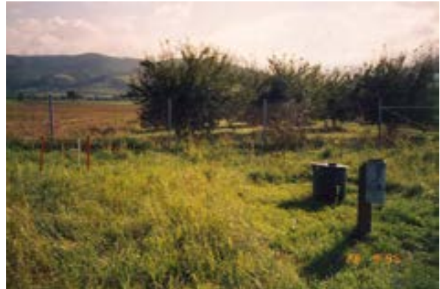
Abbildung 2.1-1: Lysimeteranlage Schriesheim im Rhein-Neckar-Raum. Im Vordergrund der Regenmesser nach Hellman (GW-Nr. 0400/305-7). Der Lysimeterbehälter (GW-Nr. 0500/305-3) wurde an der mit Fluchtstäben markierten Stelle eingebaut.
