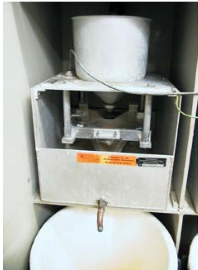
Abbildung 6.1-1 Kippwaage für die Messung der Sickerwassermenge
