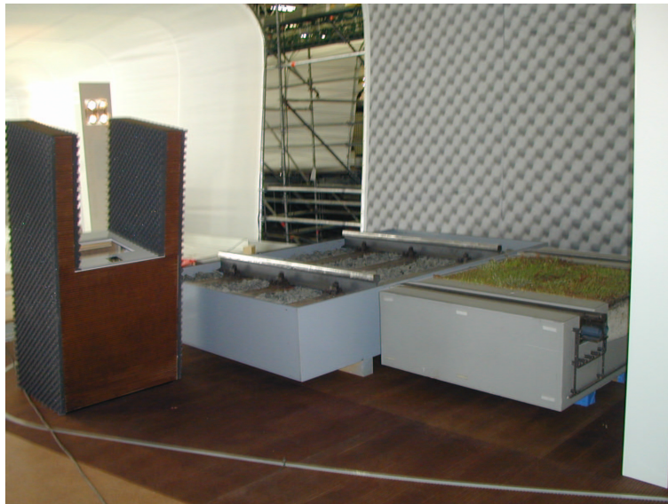
Abbildung B.4: Oberbaumodelle im Maßstab 1:1 – Seitenansicht
