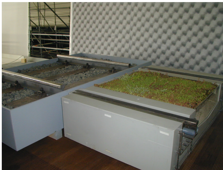
Abbildung B.3: Oberbaumodelle im Maßstab 1:1 – Frontalansicht
