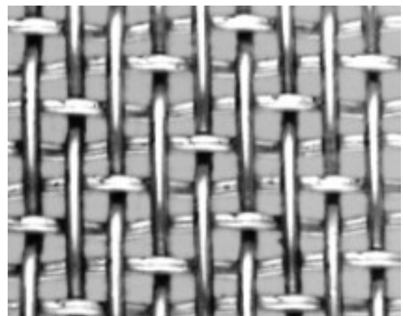
Bild 27: Gewebe in 5-Schaft-Atlasbindung, wie sie die schließlich in die Versuchsanlage eingebauten Filtergewebe aufweisen (Quelle: www.solidweave.de , besucht am 31.10.2007)
