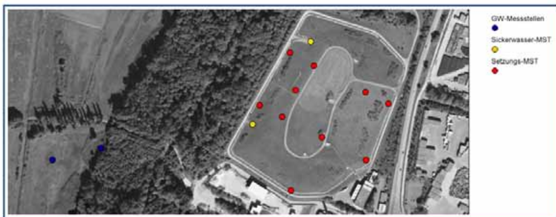
Abbildung 4: Visualisierung von Deponiemessstellen in GIS-Form
