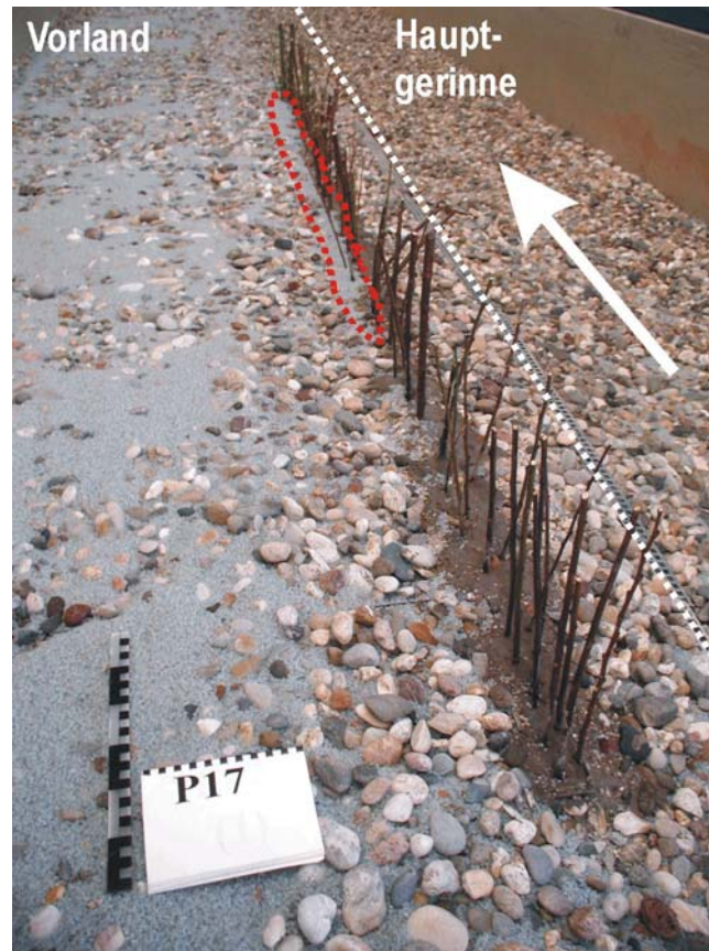
Abb. A - 20: Feststoffsedimentation (hellblaue Bereiche) bei einem einreihigen lichten Weidenbestand. (Schneider)
