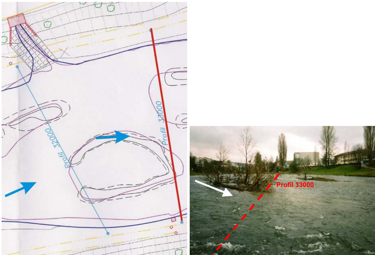
Abb. 2.3: Links: Lageplan der künstlichen Inselgruppe. Gestrichelt dargestellt sind die Grundrissänderungen zwischen 1992 und 1998. Rechts: Aufnahme der Inselgruppe vom rechten Ufer aus nach oberstrom aus dem Jahr 2000. Das Profil 33000 wurde zur Orientierung gestrichelt eingetragen.
