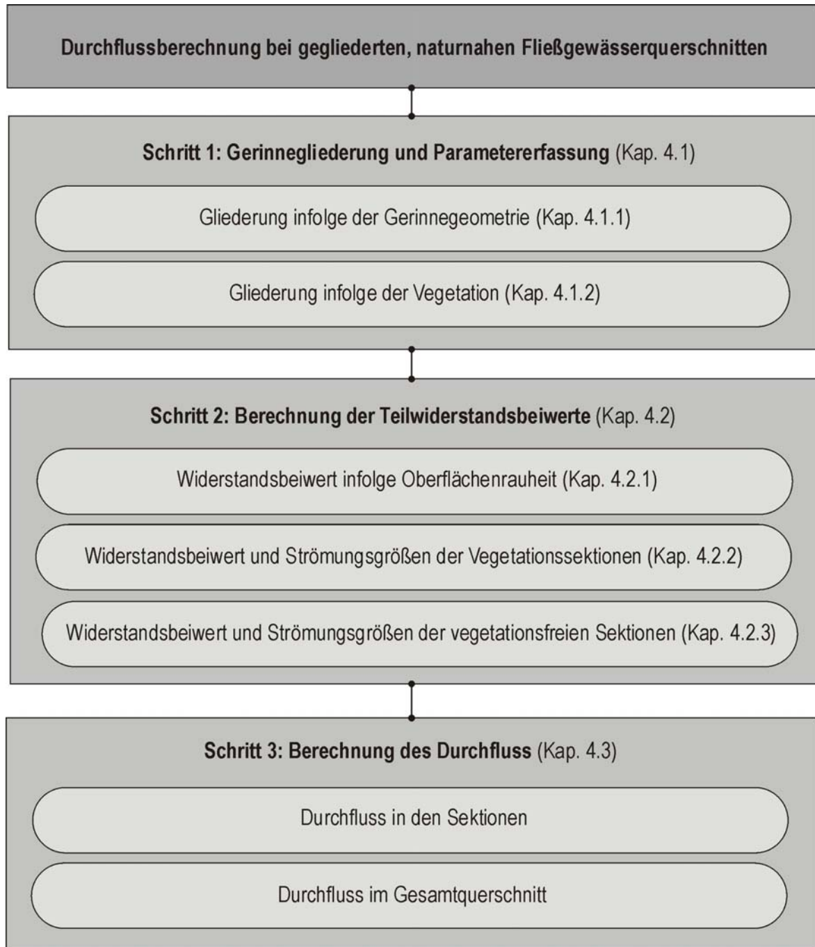
Abb. 4.2: Dreistufiges Ablaufkonzept zur eindimensionalen Strömungsberechnung naturnaher Gewässer.
