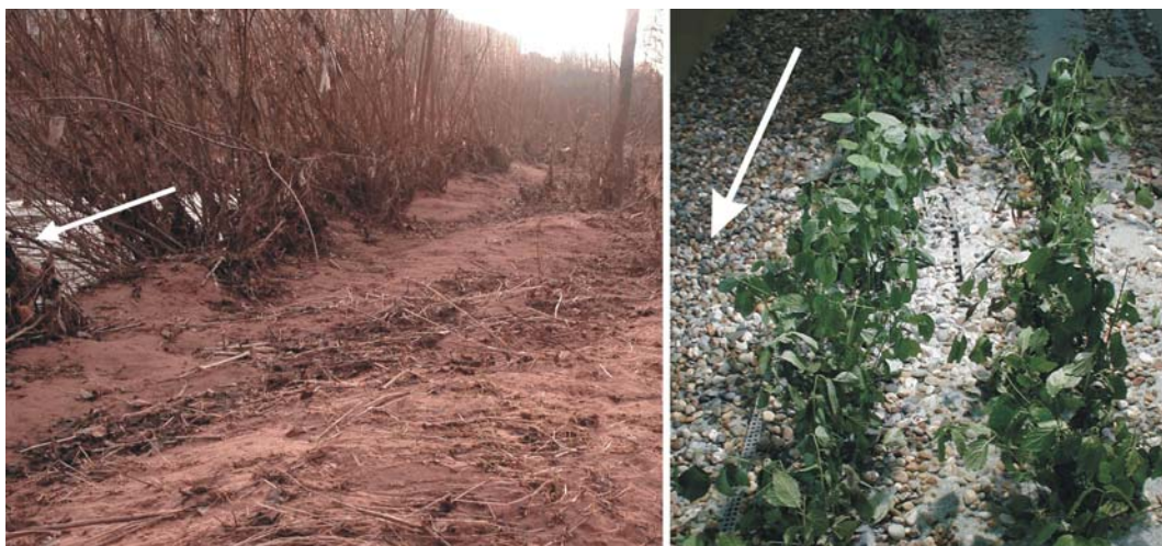
Abb. 5.9: Vergleich der Sedimentationsfelder nach einem Hochwasserereignis. Links ist die Situation in der Natur dokumentiert; rechts das Ergebnis des hydraulisch ähnlichen Modells mit abgelagerten Modellfeststoffen (hellblaue Bereiche).
