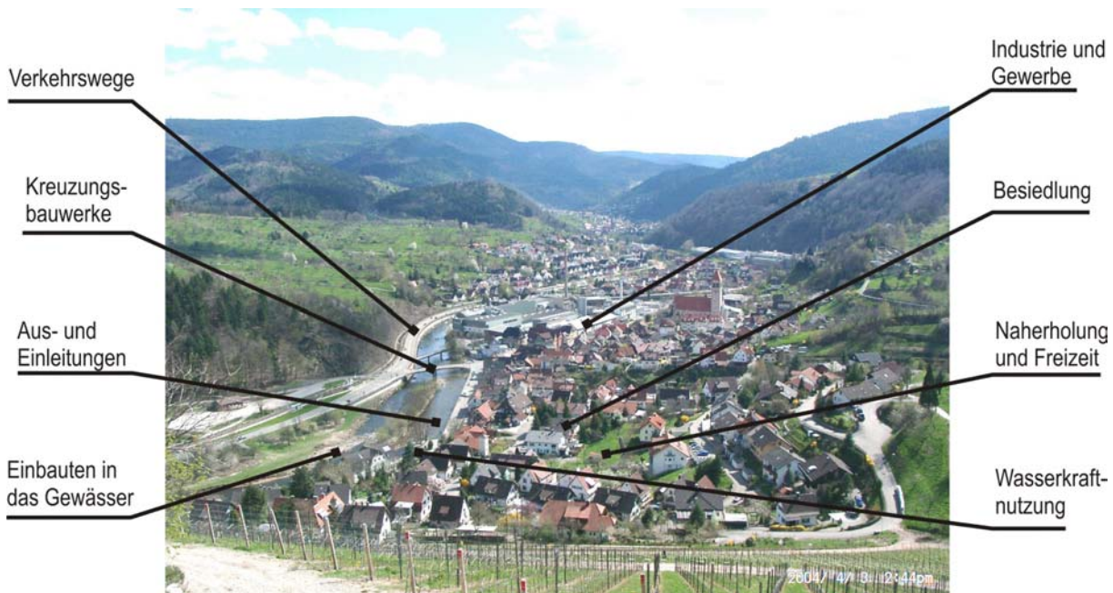
Abb. 2.10: Die ausgebaute Murg bei Gernsbach im nördlichen Schwarzwald. In dem Foto wurden exemplarisch die häufigsten anthropogenen Einwirkungen gekennzeichnet.
