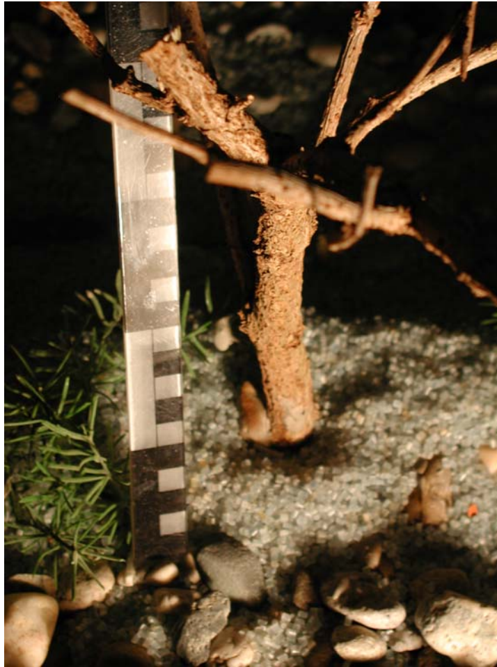
Abb. 5.11: Kolkerscheinung und Verlandungsbild um einen umströmten Stamm. (Schneider)
