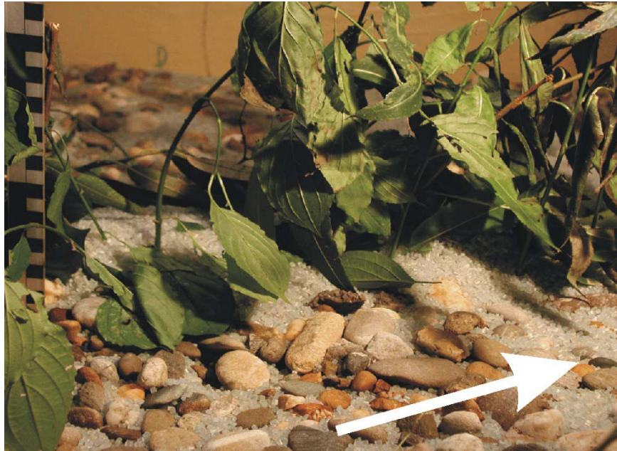
Abb. A - 24: Sedimentation innerhalb der zweiten Weidenreihe. (Schneider)
