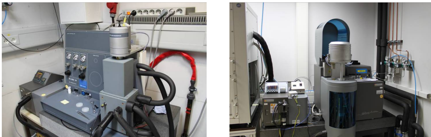
Abbildung 1 Thermowaagen Setaram TG-DSC 111 (links) sowie SetSys Evolution (rechts) zur Bestimmung der Wasseradsorptionskapazität und Durchführung der Kurzzyklisierung
