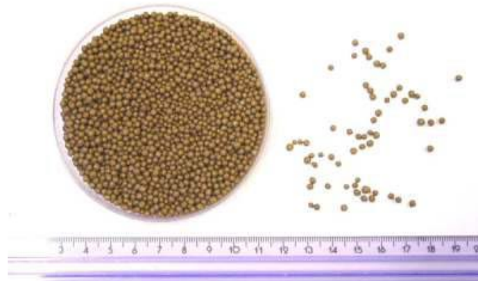
Bild 19: Phosphat-Pellets vom DHV-Crytalactorverfahren (Anonym b)
