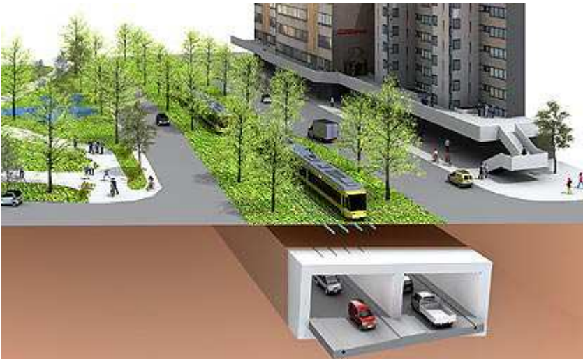
Abbildung 45: Kombilösung in der Kriegsstraße: oberirdische Straßenbahn und Autotunnel (Graphiken: Kasig)
