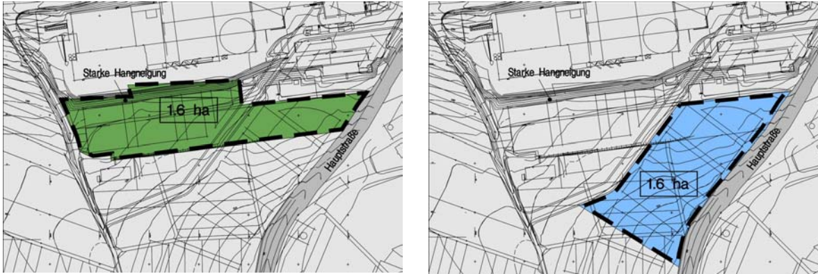
Abb.: Konstruiertes Beispiel eines Flächentauschs (Quelle: Dr. Ing. Gerd Baldauf)
