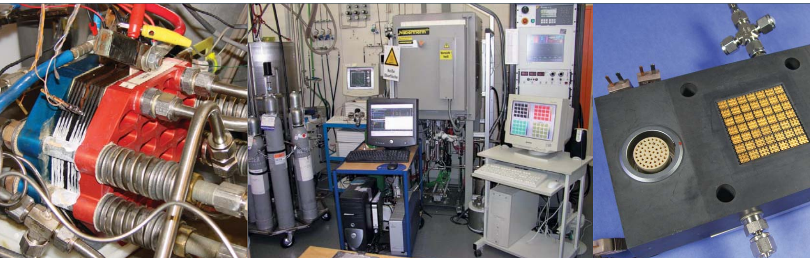
Messungen an einem aus zehn Zellen bestehenden PEM-Brennstoffzellen-Stapel Bild: ZSW
