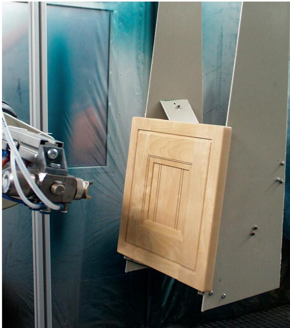
Bild 5.9: Mittels Roboter simulierte Lackieranlage mit Automatik-HVLP-Pistole
