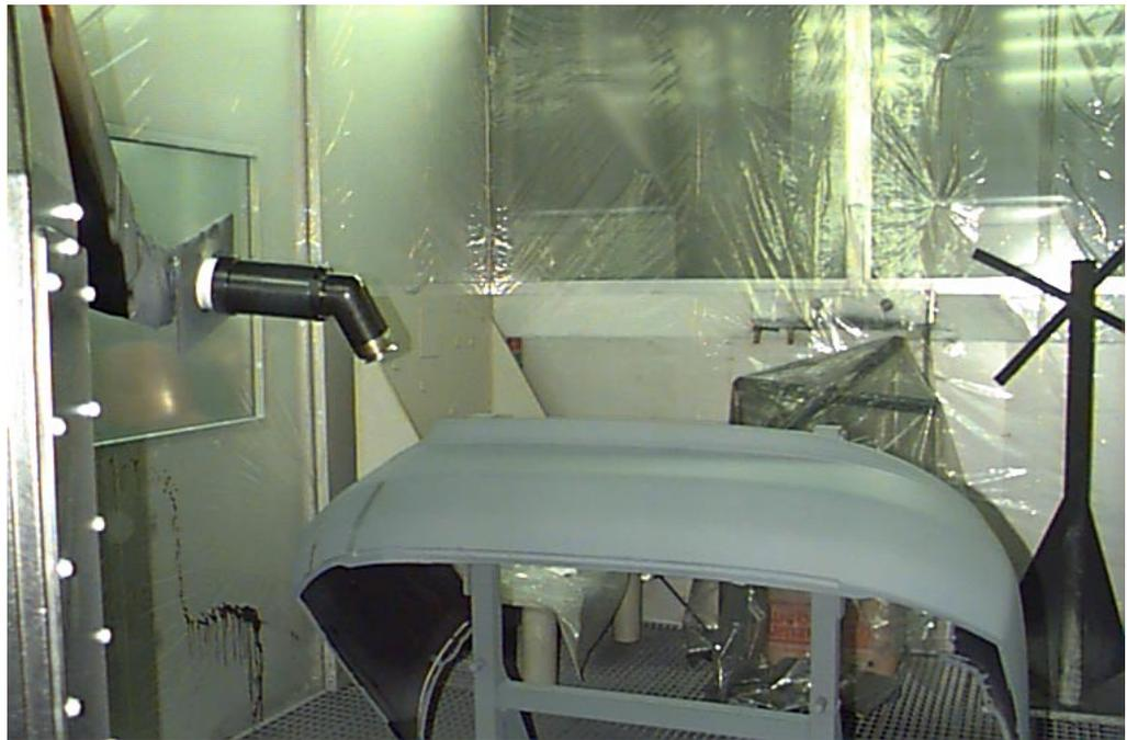
Bild 3.4: Elektrostatisches Lackieren von Stoßfängern im Lackiertechnikum des Fraunhofer IPA
