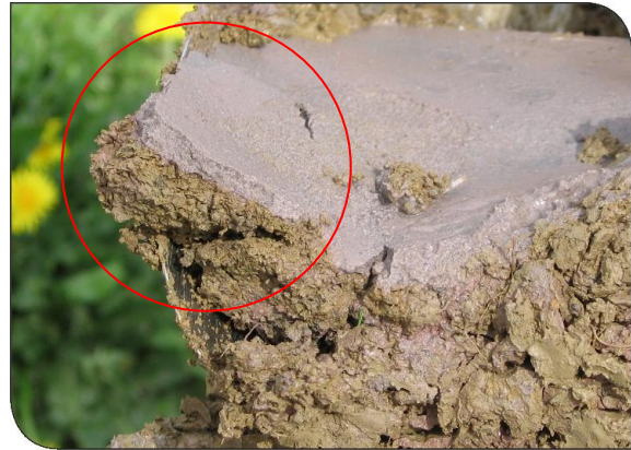
Abb. 6-1 Bodenprobe B bei BV #21 nach Abschluss der Bohrarbeiten mit Feststoffablagerung
