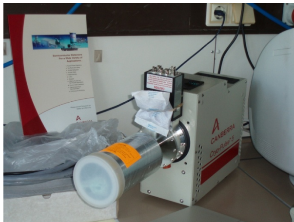
Abbildung 2.1: HPGe-Detektor, Model XtRa, mit einer dünnen Einschnürung zwischen dem Kristallkopf und dem Vorverstärker und Kompressor.
