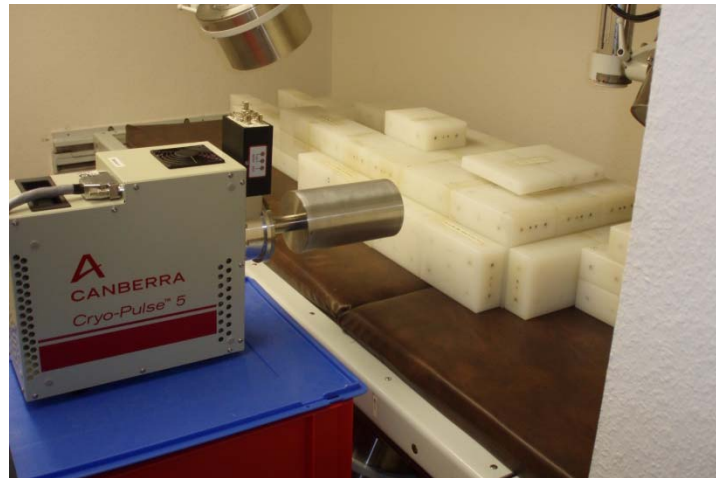
Abbildung 5.8: Position des zweiten Detektors an der linken Seite des Phantoms (in diesem Fall ein P4, das mit einer zusätzlichen Decklage und radioaktiven Stäben, wie im Text beschrieben, modifiziert wurde).
