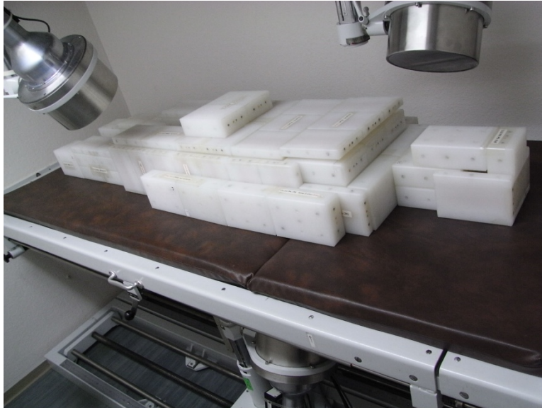
Abbildung 5.5: Aufbau mit dem Phantom P5. Der Detektor unten rechts ist im Bild nicht sichtbar, da er über der rechten Hüfte angeordnet ist und auf den Mittelpunkt des Phantoms weist.
