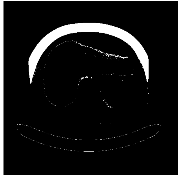
Abbildung 3.20: Differenzbild wie in Abbildung 3.19, jedoch mit um ein Voxel nach oben verschobene Aufnahme von Overlay Nr. 4. Zu erkennen sind hier deutlich weniger Differenzvoxel.
