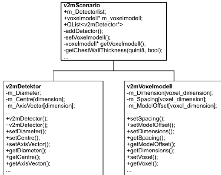
Abbildung 3.3: Ausschnitt aus Voxel2MCNPs objektorientierter Struktur dargestellt als UML-Diagramm (Unified Modeling Language) [Fow03]. Die Klasse v2mScenario wird vererbt an die Unterklassen v2mDetektor und v2mVoxelmodell. Die Information der Detektor- oder Voxelmodell-Objekte (die Instanzen der jeweiligen Klassen) sind in den sogenannten Membervariablen gespeichert (Präfix: m_). Die Plus- und Minuszeichen zeigen an, ob eine Methode öffentlich (engl.: public) also zugänglich von einer anderen Klasse ist, oder geschützt (engl.: private), d.h. sie ist nur zugänglich innerhalb der Klasse.
