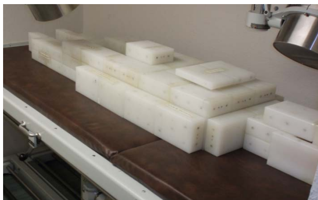
Abbildung 5.10: Phantom P4 mit Blöcken und radioaktiven Stäben über dem Torso.
