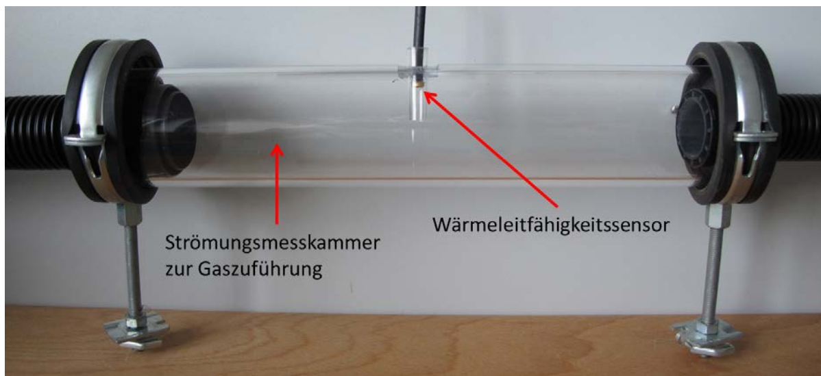
Abbildung 9: Vorläufiger Aufbau zur Charakterisierung des WASABI Sensors. Senkrecht zur Strömungsrichtung des Messgases ist der Sensor in der Mitte des Rohres (30 cm Länge, 6,5 cm Durchmesser) angebracht.
