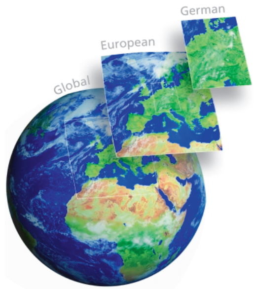
Abb. 1: Prinzip des dynamischen Downscaling. Quelle: Süddeutsches Klimabüro
