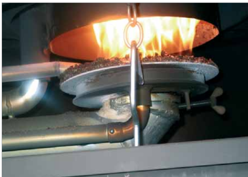
Unterschubbrenner in einem neuartigen Pelletofen. Ein Pelletofen erzeugt weniger Emissionen als ein Scheitholzofen, weil das Holz besser verbrannt wird.
