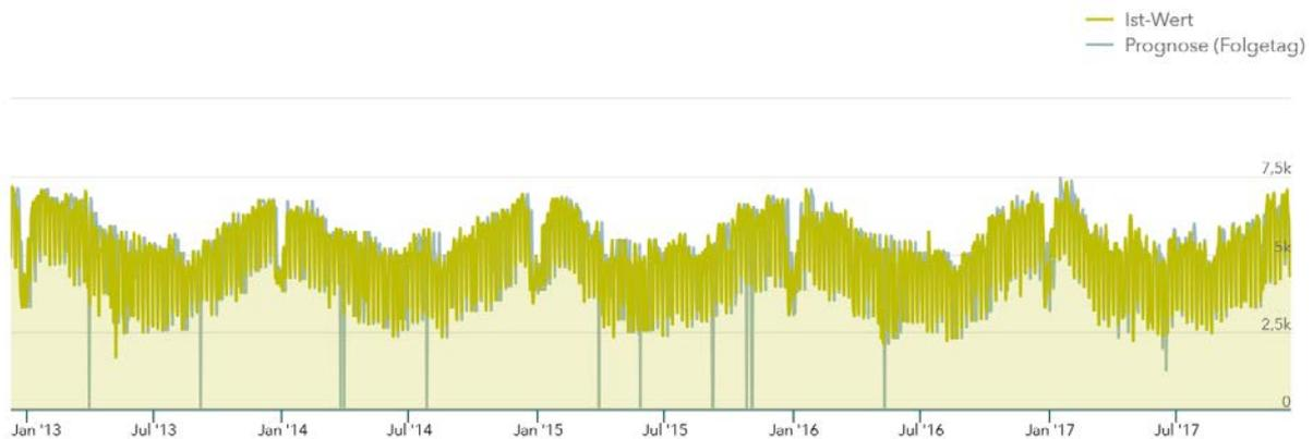
**Bild 2: Vertikale Netzlast Transnet BW (2013 - 2017) <sup>9</sup>**
