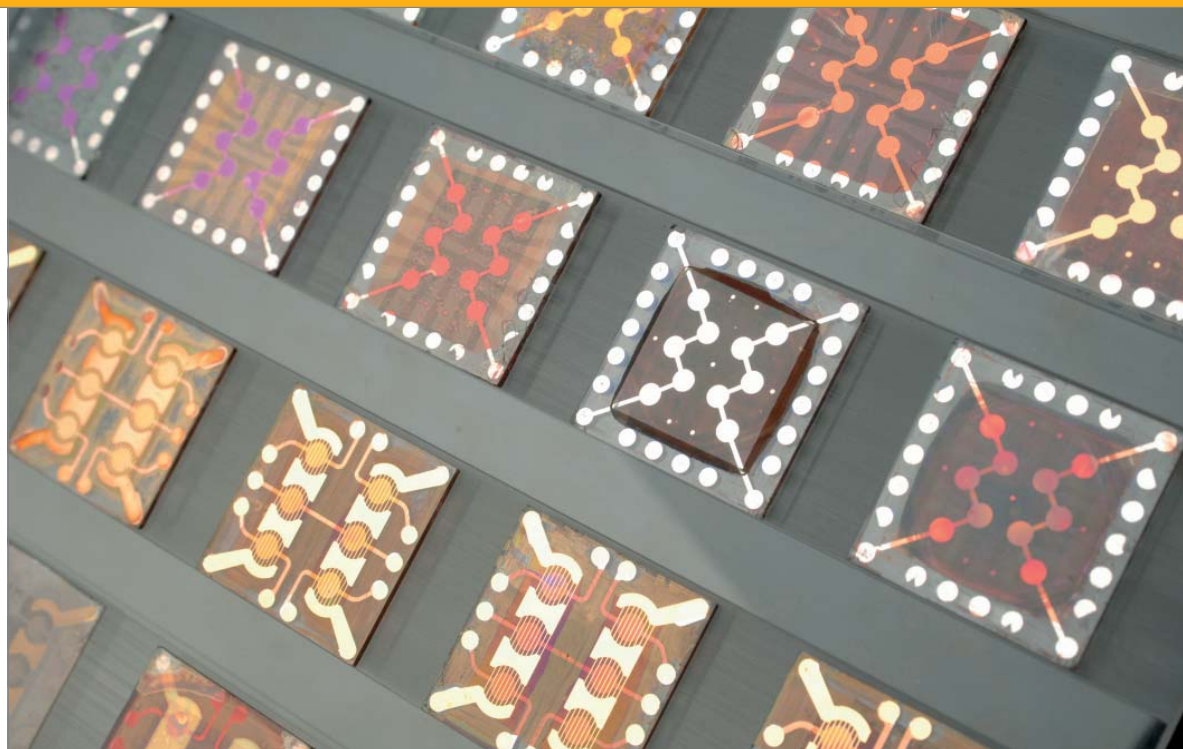
Teststrukturen zur Untersuchung organischer Solarzellen
