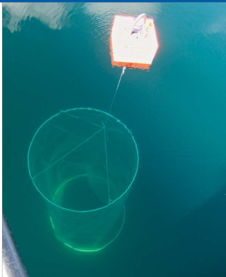
Drifter im Einsatz: Ein Styroporkörper hält das GPS-/GSM-Modul und die Beleuchtung an der Oberfläche; unter Wasser ist das Segel zu sehen.
