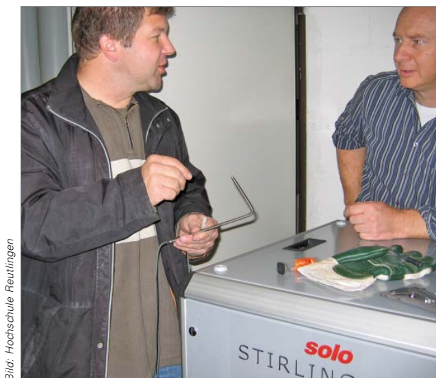
Ein LUBW- und ein Kläranlagen-Mitarbeiter bei der Abgasanalyse am Stirling-Mikro-KWK
