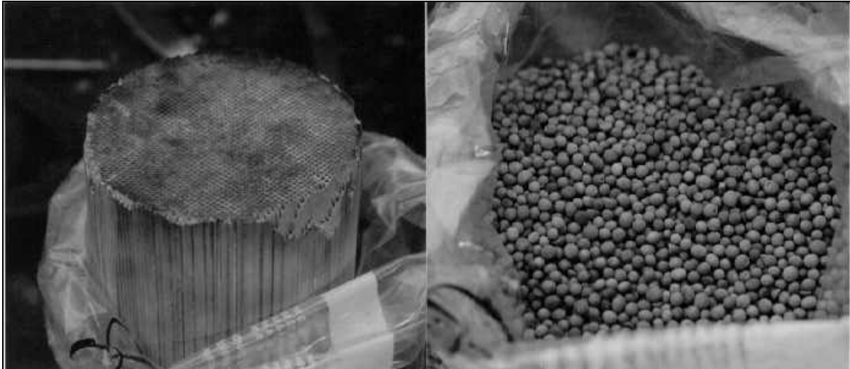
Abb. 1: Verschiedene Ausführungen von Katalysatoren: links Wabenform, rechts Schüttgutform
