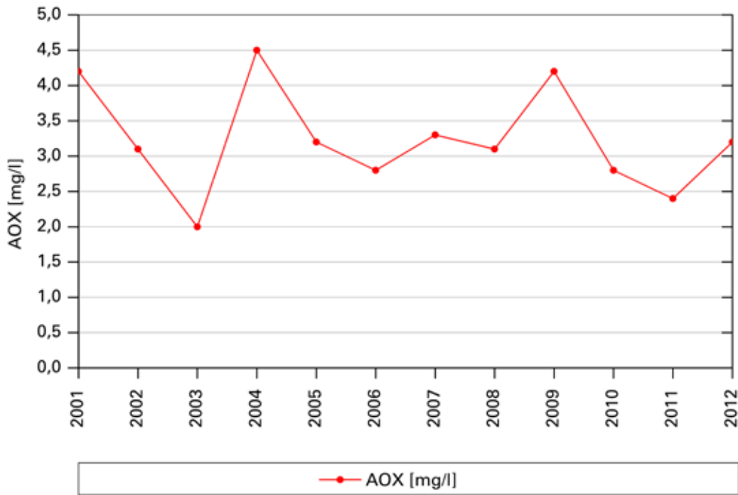
Abb. 10: Sickerwasser Jahresmittelwerte der AOX Konzentration 2001 – 2012
