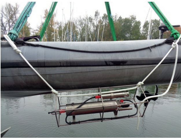
Abb. 5-13: Messaufbau für die überflugsynchronen Messkampagnen in der Blitzenreuther Seenplatte – Schlauchboot mit geschleppter Multiparametersonde.
