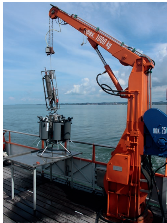
Abb. 5-4: Forschungsschiff Kormoran. Schiffskran mit Multiparametersonde und Rosettenwasserschöpfer zur Messung seenphysikalischer Parameter und zur Entnahme von Wasserproben für chemische und isotopeanalytische Untersuchungen.
