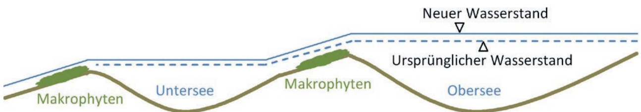
Abb. 1-41:Schema zum Aufstau des Untersees und des Obersees des Bodensees durch vermehrten Makrophytenbewuchs in den Ausstrombereichen.
